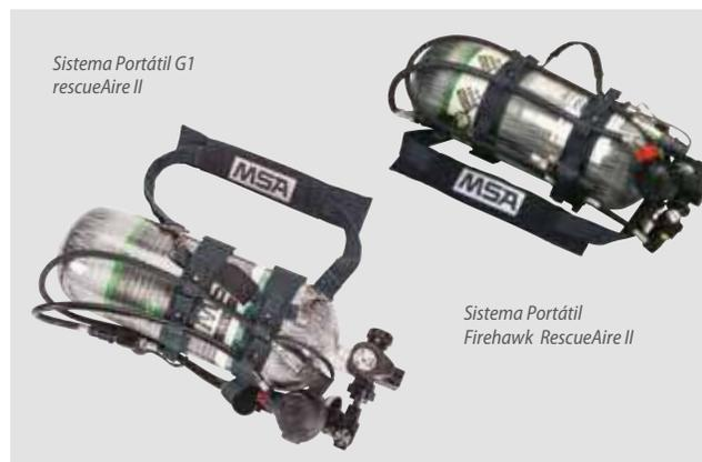
El sistema portátil de suministro de aire RescueAire II satisface las necesidades de los equipos de intervención rápida (RIT). El sistema completo consta de un cilindro liviano envuelto en carbono, un sistema de llenado rápido Quick-Fill, un sistema ExtendAire para respiración de emergencia, un regulador MMR y un arnés resistente al fuego y al calor. Está disponible en dos versiones: baja presión (2216 psig) y alta presión (4500 psig).
