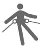
**Anillos cadera:** Para posicionamiento o restricción; estos sistemas permiten al usuario mantenerse suspendido en elevación frente a su área de trabajo, de manera cómoda para trabajar con las manos libres.
