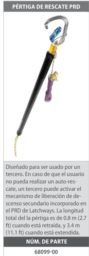
Diseñado para ser usado por un tercero. En caso de que el usuario no pueda realizar un auto-rescate, un tercero puede activar el mecanismo de liberación de descenso secundario incorporado en el PRD de Latchways. La longitud total de la pértiga es de 0.8 m (2.7 ft) cuando está retraída, y 3.4 m (11.1 ft) cuando está extendida.
