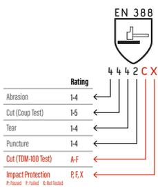
El puntaje de desempeño EN 388 aparece en las marcas como tal. Cada número representa una característica de desempeño específica. La revisión de 2016 incluyó dos posiciones más. La quinta posición indica el puntaje de prueba de TDM y la sexta posición indica el puntaje de prueba de resistencia contra impactos.
